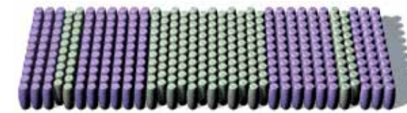
Schematische Darstellung fest: 1,8mm parallel, 2,0mm versetzt
